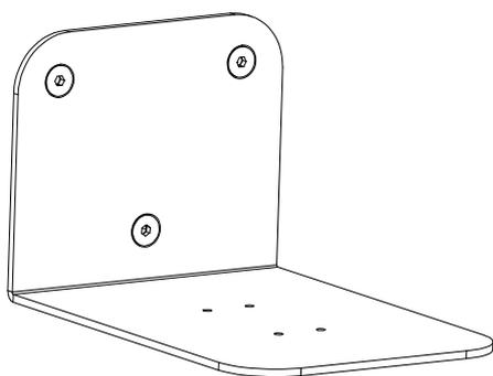
Halterung für die Montage der Lampen UV-C Sterilon FLOW.
