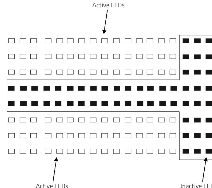
PL W tej wersji oprawy, część diod LED nie jest aktywna. Jest to celowe rozwiązanie konstrukcyjne, a nie efekt przepalenia diod.
