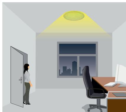
Bei nicht ausreichender Lichtmenge im Raum, schaltet der Sensor die Leuchte nach der Erkennung von Bewegung automatisch ein.
