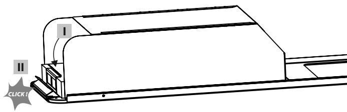
**FR** Avant de remplacer le filtre, éteignez l'appareil et assurez-vous que les sources lumineuses UVC sont éteintes. Lors du remplacement du filtre, portez un masque de protection couvrant la bouche et le nez et portez des gants de protection.
