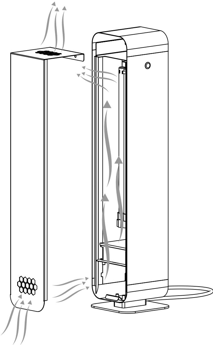
Lampy przepływowo UV-C STERILON FLOW
