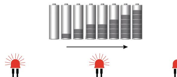
„Jeśli oprawa w trakcie rozładowania akumulatora (w trakcie świecenia) zacznie pulsować białymi diodami to należy rozpocząć proces ładowania akumulatora (przywrócić zasilanie do oprawy). W przeciwnym wypadku akumulator ulegnie dalszemu rozładowaniu i diody zgasną całkowicie.”
