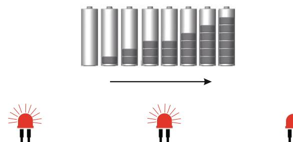
„Jeśli oprawa w trakcie rozładowania akumulatora (w trakcie świecenia) zacznie pulsować białymi diodami to należy rozpocząć proces ładowania akumulatora (przywrócić zasilanie do oprawy). W przeciwnym wypadku akumulator ulegnie dalszemu rozładowaniu i diody zgasną całkowicie.”
