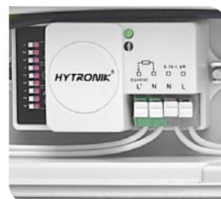
Die Anwendung eines Mikrowellen-Bewegungsmelders (RCR) gewährleistet die Bereitstellung von Licht zu der Zeit und an dem Ort, an dem dieses benötigt wird, was eine Energieersparnis ermöglicht.
